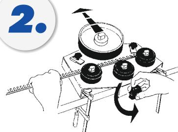
Die BIEGESCHEIBE wird mit dem DREHKNOPF von den HALTERROLLEN weg bewegt. Anschließend wird das Profil eingelegt und zwar so, daß das Profil an beiden HALTERROLLEN anliegt. (Die ersten 15 cm werden manuell nachgebogen oder entfernt). Anschließend die FÜHRUNGSROLLE mit dem beigefügten Schlüssel lockern.
