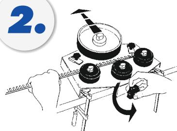
Décaler le DISQUE DE PLIAGE des POULIES DE MAINTIEN à l'aide du BOUTON deréglage. Mettre ensuite le profilé en place de sorte qu'il vienne buter contre les deux POULIES DE MAINTIEN (les premiers 15 cm sont introduits à la main ou supprimés). Désserrer la POULE DE GUIDAGE à l'aide de clé fournie.
